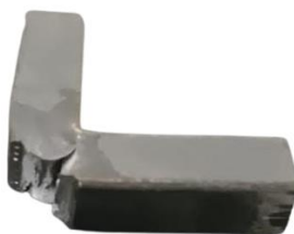
Figura 10. Estado de la probeta después del impacto.
