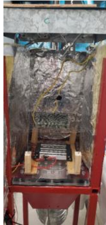
Figura. 1 Prototipo del túnel de secado
