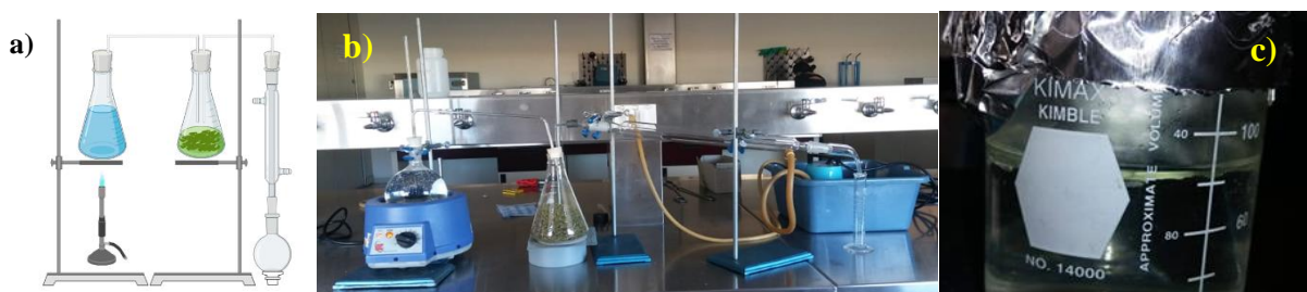
Figura 1: Equipo de destilación a) diseño preliminar por arrastre con vapor, b) dispositivo montado, c) aceite esencial de orégano obtenido.
