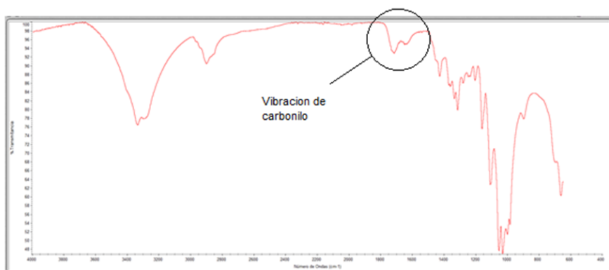
Espectro 3. Resultado de análisis FT-IR de experimento con 8.064 g de ácido cítrico.
