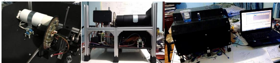
Figura 5. Construcción, ensamble y puesta en marcha del sistema de Nefelometría multi-espectral.
