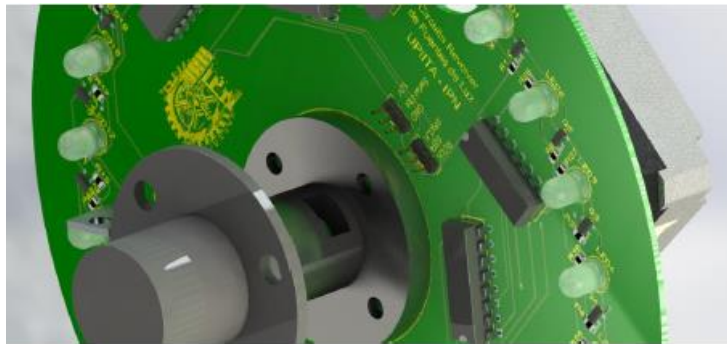
Figura 3. Diseño del revolver de fuentes de luz.
