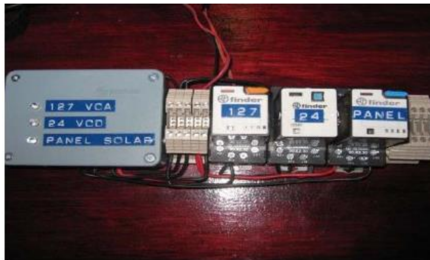
Figura No. 6 Montaje en riel DIN del circuito electrónico y de control diseñados
