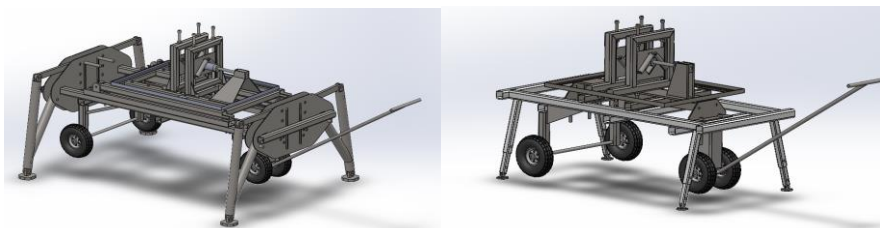
Figura 1. Vista isométrica de primera (izquierda) y segunda (derecha) iteración de diseño conceptual.
