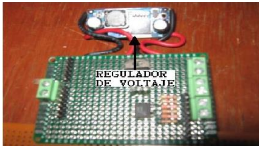
Figura No. 4 Conexión del regulador de voltaje al circuito armado en la placa fenólica
