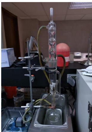
Figura No.5.- Equipo Soxhlet como método de extracción de ácidos grasos.
