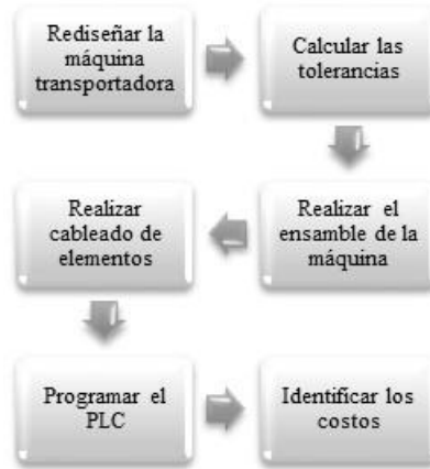
Figura 1. Método para el rediseño de un sistema de báscula de pesado Fuente: Elaboración Propia
