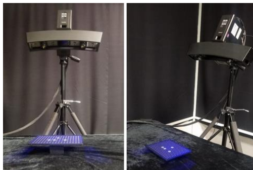
Figura 1. Calibración del escáner 3D
