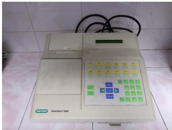
Figura No. 7.- Espectrofotómetro, usado para la caracterización de ácidos grasos.
