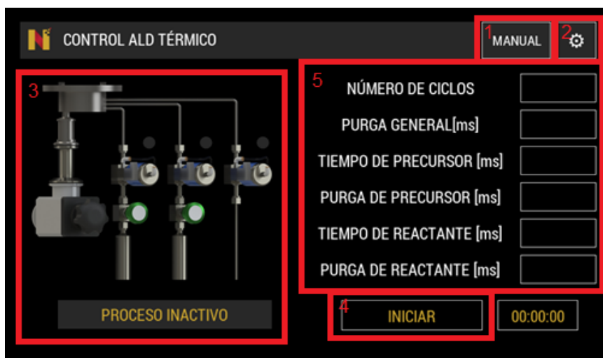
Figura 3. Pantalla principal de interfaz gráfica de control. 1) Control de apertura manual de las válvulas, 2)
