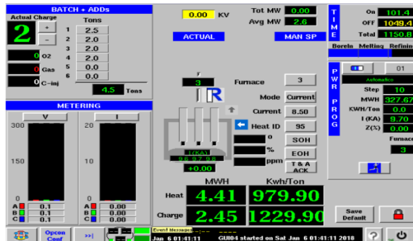
Figura 7. Pantalla de operación del horno
