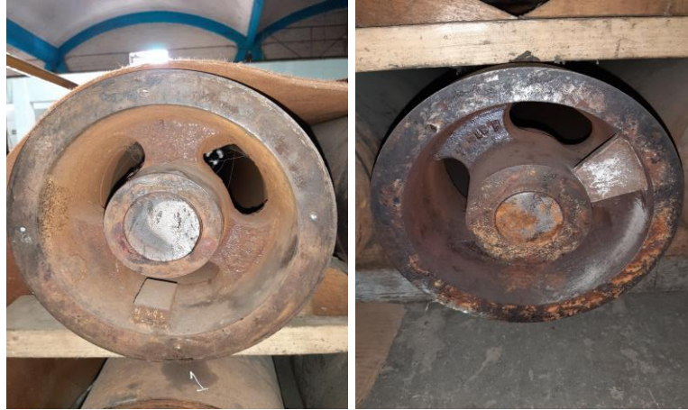
Figura 3. Espigas de rodillos con falla por fractura mecánica en zona de tapa
