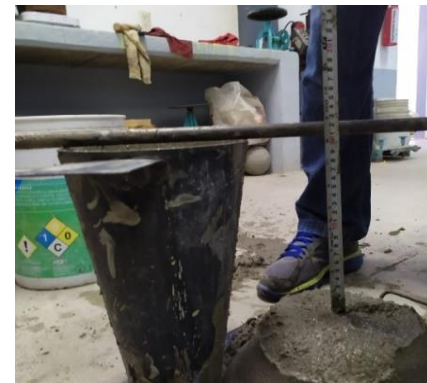
Figura 3: Revenimiento del mortero
