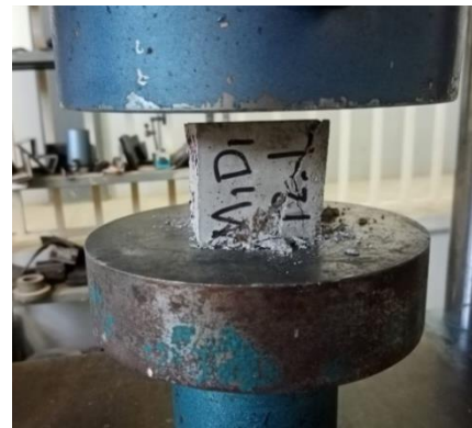
Figura 5: Cubo sometido a compresión
