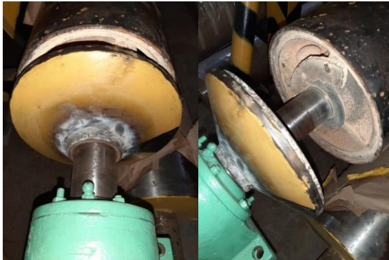
Figura 5. Condición de espiga con tapa curva
