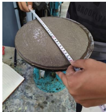
Figura 2: Determinación de la fluidez
