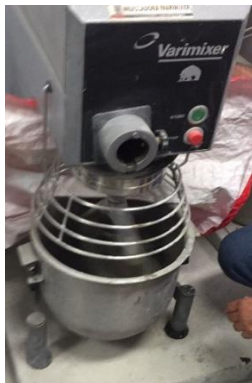
Figura 1: Mezclado mecánico del mortero
