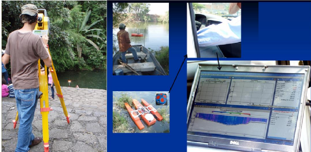
Figura 1. Obtención de la geomorfología fluvial mediante estación total, ecosonda y GPS.
