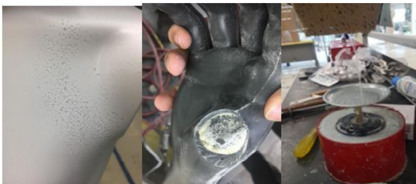
Figura 1. (a) Pieza quebrada por falta de mold reléase, (b) Poros por exceso de mold reléase y (c) Bomba manual de mold release
