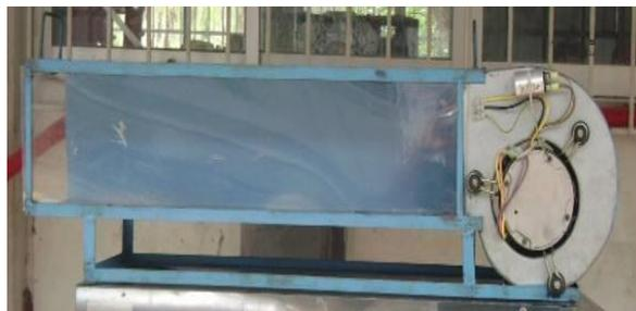
Figura 5. Túnel de Viento de Baja Velocidad
