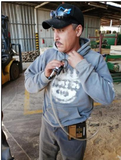
Figura 2. Colocación del tren de muestreo en el trabajador.
