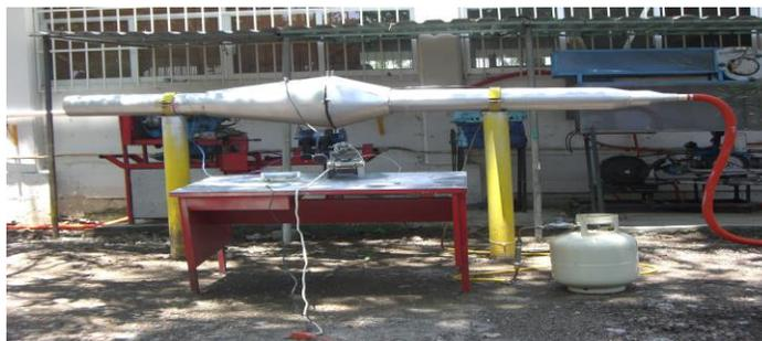
Figura 3. Cámara de Combustión Experimental
