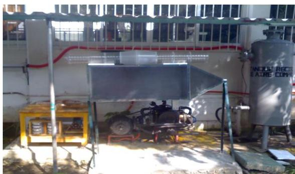
Figura 4. Túnel de Viento de Alta Velocidad
