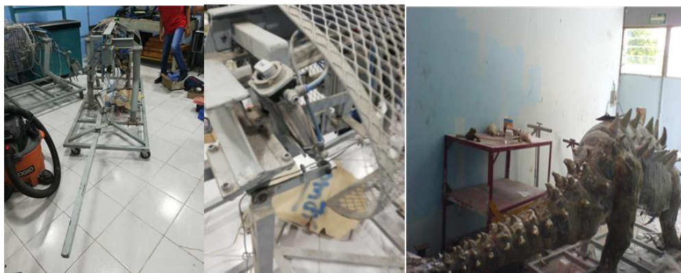
Figura 9 Desarrollo del diseño desde la estructura, mecanismo e integración final de la cola.
