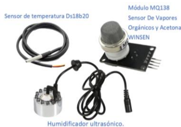
Figura 8. Humidificador y sensores.
