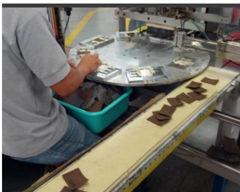
Figura 3. Máquina de troquelado (estampado) automático. Elaboración propia. 2020.
