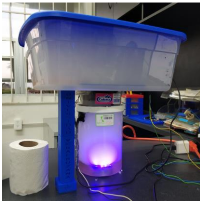
Figura 11. Cámara de vapor de acetona con humidificador ultrasónico.
