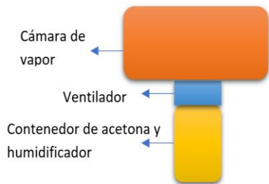
Figura 7. Estructura representativa de la cámara de vapor con humidificador ultrasónico.
