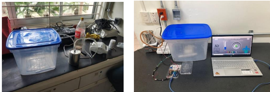
Figuras 4 y 5. Cámara de vapor de acetona con calor inducido.
