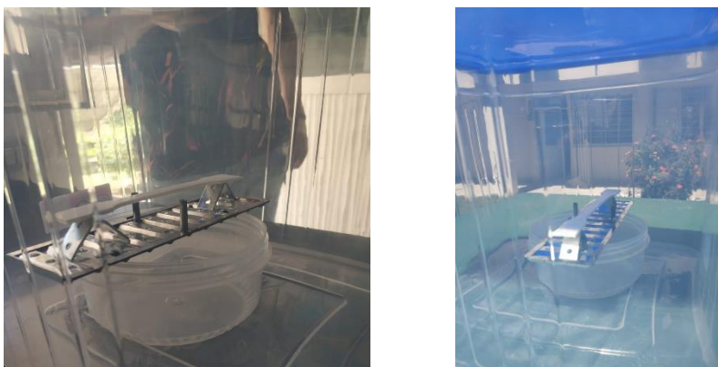
Figuras 1 y 2. Interior de la cámara de vapor de acetona a temperatura ambiente.
