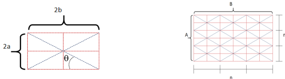
a) Celda unitaria patrón de Yoshimura b) Patrón para una estructura de Yoshimura que presenta movimientos de flexión
