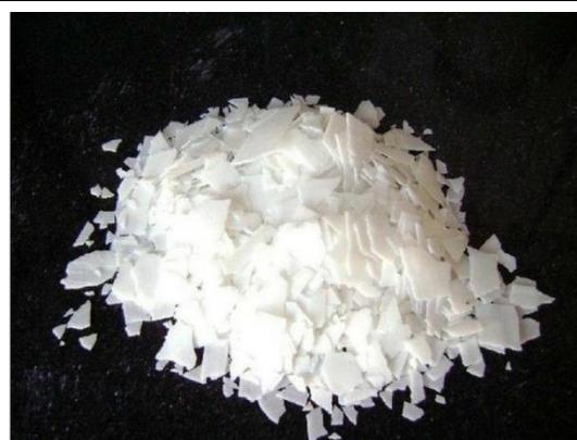
Fig 5. Activador alcalino (hidróxido de sodio) en presentación de escamas.
