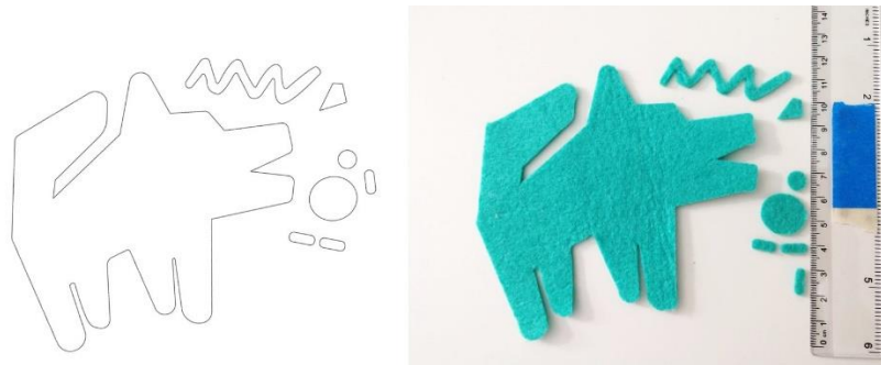
Figura 2. Comparativo entre dibujo CAD y maquinado sobre fieltro CAM
