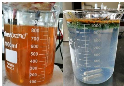
Figura 1. Proceso de electrocoagulación del naranja de metilo etapa inicial y final.
