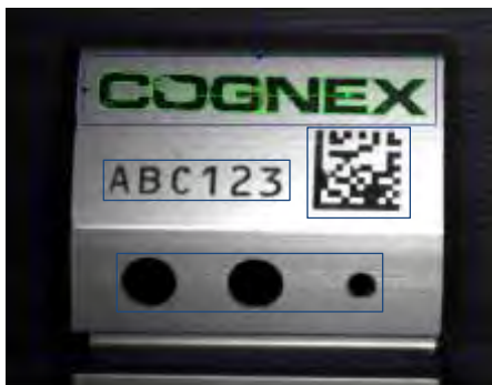
Imagen 3: Regiones críticas inspeccionada por el sistema de visión.
