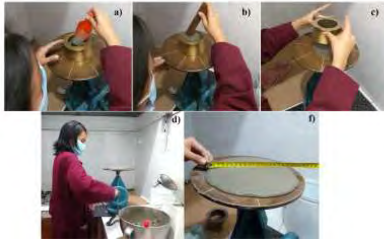
Figura 2.- Prueba de fluidez en mezclas de mortero
