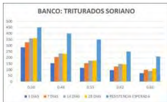
Fig 4. Resistencias a la compresión por edades obtenida por bancos
