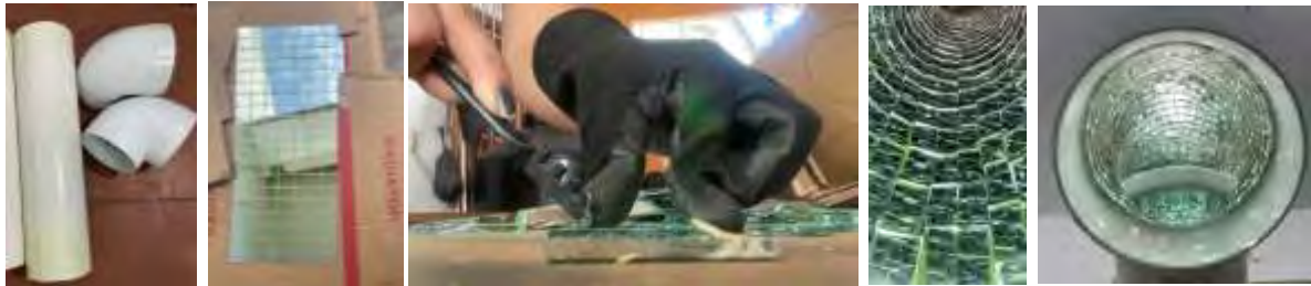
Figura 3. Fabricación del Tubo de Iluminación Solar con espejos interiores orientados.
