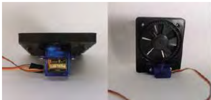
Figura 2. Ventilador con motor.
