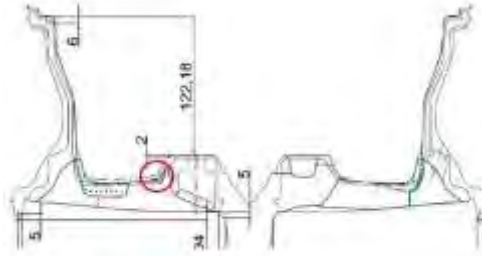
Figura 4. Vista de sección de perfil de un rin y en rojo las zonas que restringen el llenado de la pieza.
