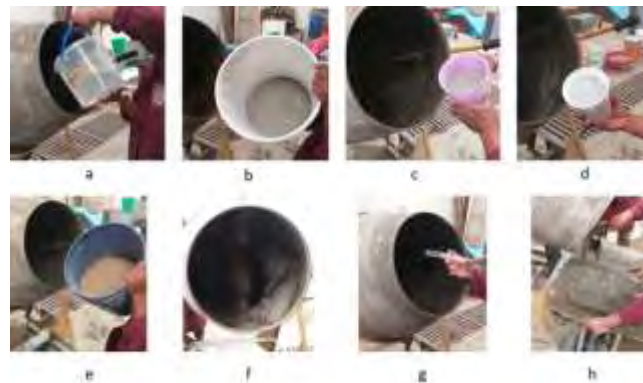
Figura 4. Elaboración de mezcla 2 de mortero ecológico y ligero. a) Adición de agua, b) adición de cemento, c) adición de CV, d) adición de PVa e) adición de agregado fino, f) mezclado, g) adición de reductor de agua, h) mezcla terminada
