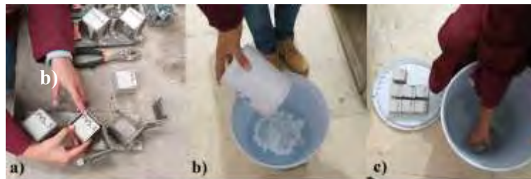
Figura 4.- Desmolde y curado de probetas cúbicas.
