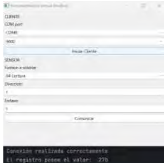
Figura 5. Interfaz en funcionamiento desplegando en consola el registro solicitado.
