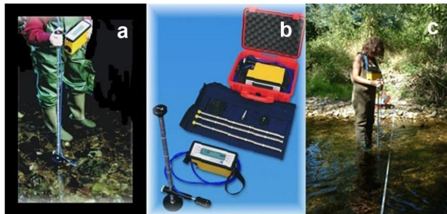
Figura 4. a. Medición de la velocidad del agua (izquierda), b. equipo de medición con accesorios, c. Medición de la distancia al elemento de marqueeo, la profundidad y la velocidad en un punto de una sección transversal.
