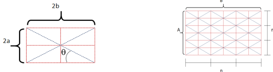
a) Celda unitaria patrón de Yoshimura b) Patrón para una estructura de Yoshimura que presenta movimientos de flexión
