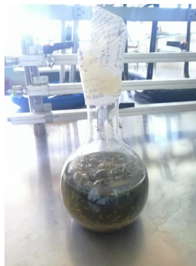
Figura 4. Maceración en frío del material vegetal con agua como agente extractor.
