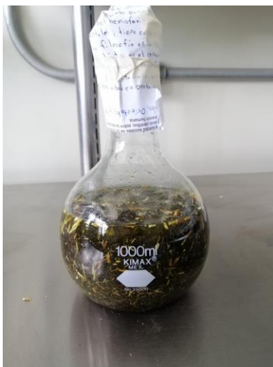
Figura 3. Maceración en frío del material vegetal con etanol como agente extractor.
