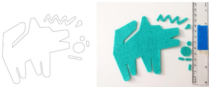
Figura 2. Comparativo entre dibujo CAD y maquinado sobre fieltro CAM
