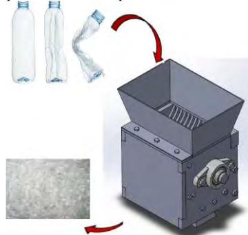
Figura 1. Proceso de maquinado para los residuos plásticos.
