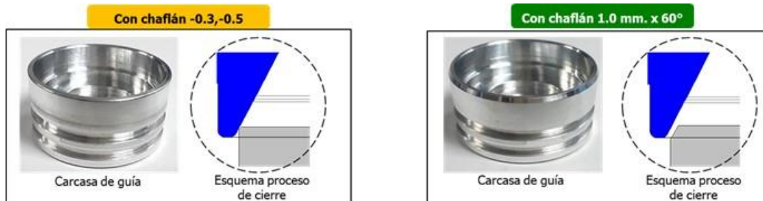
Figura 3. Comparativo de imagenes de chaflanes vs herramienta de cierre.
