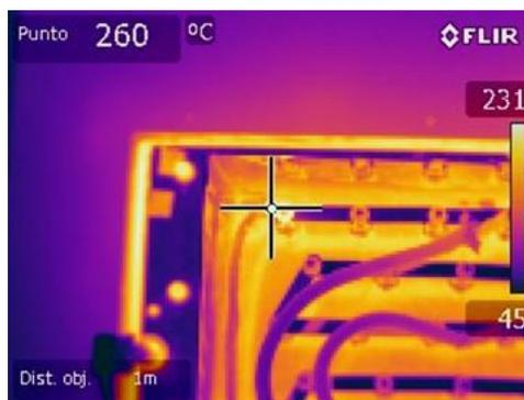
Imagen 13. Punto caliente en la conexión eléctrica en resistencia de hornos.
