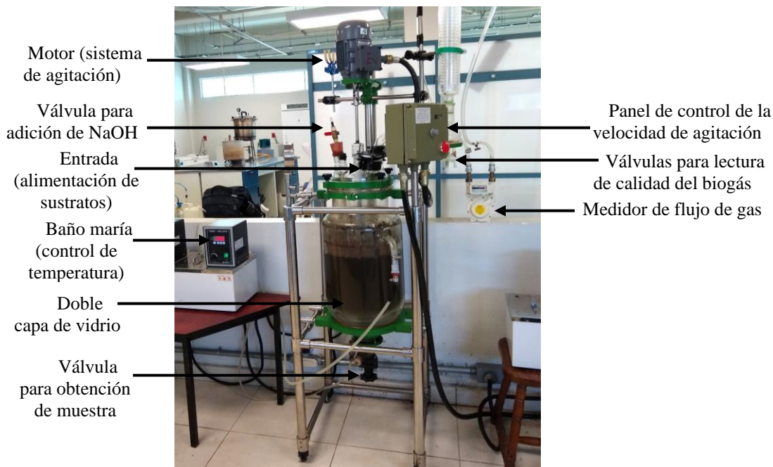
Figura 1. Biorreactor anaerobio CSTR y sus componentes principales.
