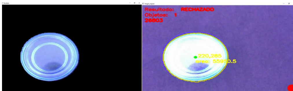
Figura 7 Separación objeto del fondo e imagen tomada con exceso de iluminación
