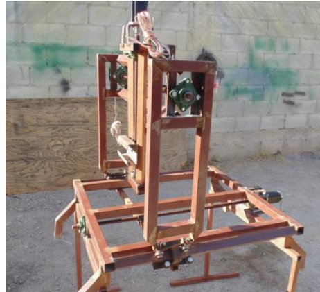
Figura 3. Estructura de perfil tubular de 2 pulgadas.
