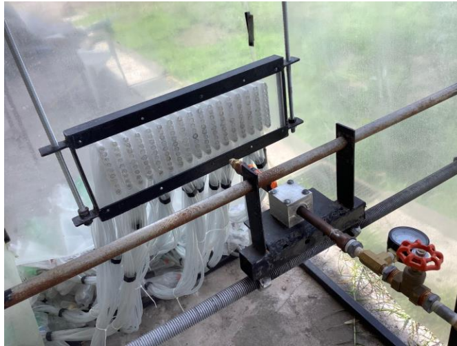
Figura 1. Diseño experimental para determinar la densidad de impacto de los rocíos.
