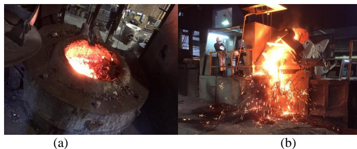
Figura 1. a) Fusión de la materia prima en un horno de inducción y b) nodulización de la fundición mediante el método sándwich.
