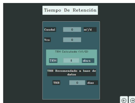
Figura 5. Datos del tiempo de retención hidráulico (TRH). Fuente: Elaboración propia (2022).
