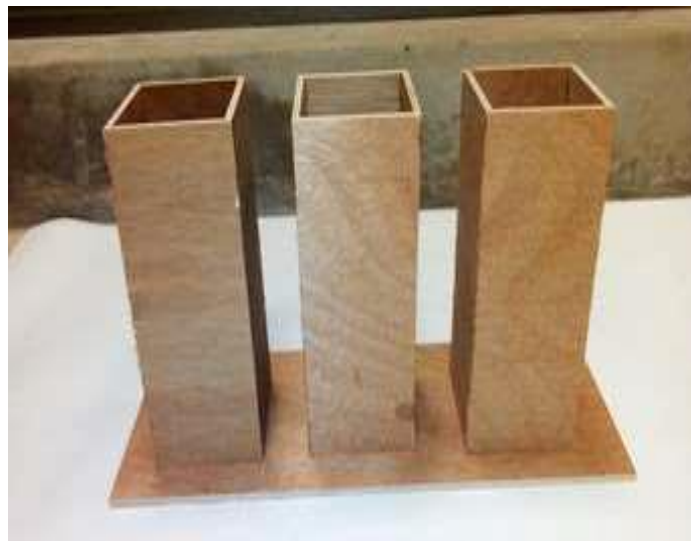
Figura 1.4. Armado de la parte interna del molde de block
