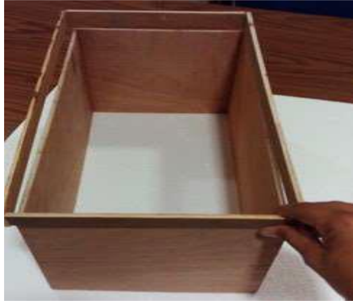
Figura 1.3. Armado de la parte externa del molde de block
