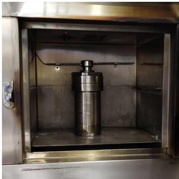
Figura 2. Reactor para el Proceso de CHT.
