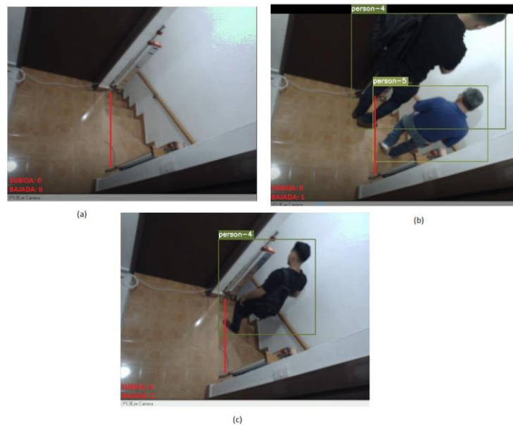
Figura 3. Secuencia de descenso (bajada) de escaleras. (a) La línea de cruce (línea roja) se coloca a la par de las barras con sensores infrarrojos. En la parte inferior izquierda de la pantalla se muestran los conteos de subidas
