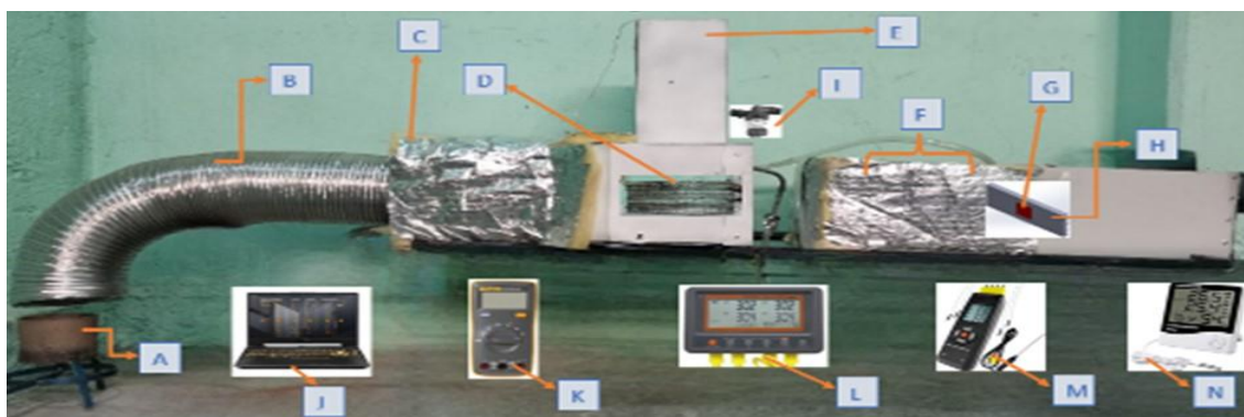
Figura 1. Cosechador de energía residual para la generación de diferencia de potencial vía TEM. Equipo real. Partes del cosechador A. Quemador B. Ducto de gases de combustión. C. aislante térmico. D. Recuperador de calor de tubo aleteado E. Sistema chimenea F. Batería térmica G. Módulo TEG H. Disipador de calor de aletas rectangulares. I. Bomba de agua.
