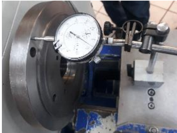
Imagen 5.- verificación geométrica en cabezal
