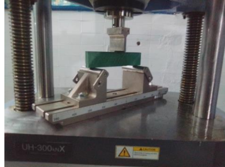
probeta instalada en la maquina Universal SHIMADZU
