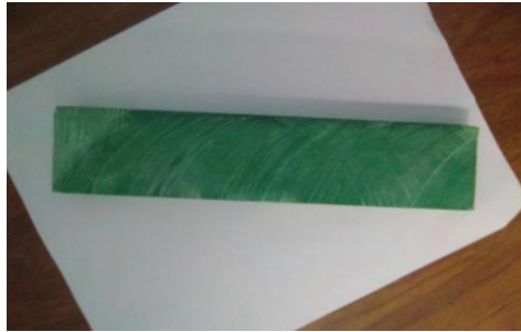
probeta de NECURON 1001 antes de la prueba de ensaye de flexión
