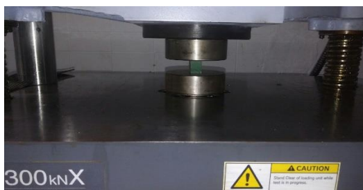
Probeta del material de NECURON 1001 instalada en la maquina universal SHIMADZU
