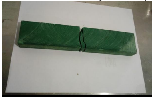
probeta de NECURON 1001 después del ensaye de flexión
