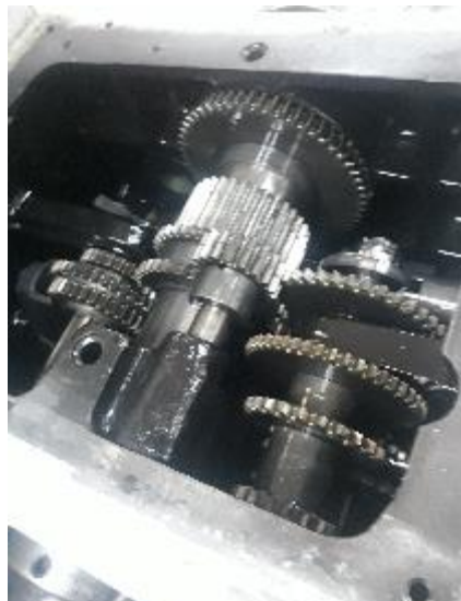
Imagen 4.- Análisis cinemático y cinético de la caja de velocidades de un torno convencional.
