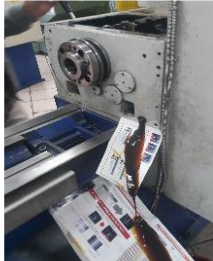
Imagen 2.- Inspección de la caja de velocidades de un torno convencional y su calidad de aceite.
