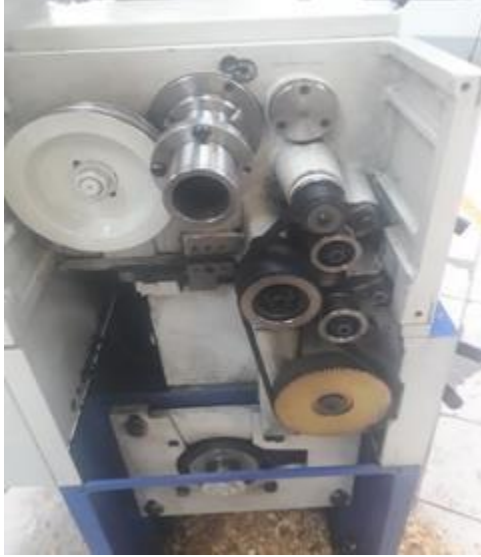
Imagen 1.- Inspección de la transmisión por bandas, de un torno paralelo convencional.
