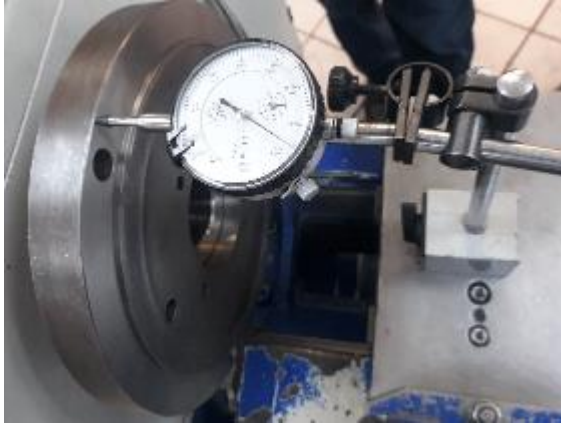
Imagen 5.- verificación geométrica en cabezal
