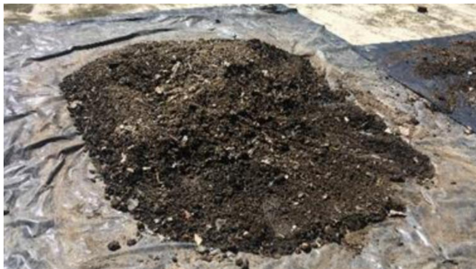
Figura 2. Material estabilizado empleado para empacar a al biorreactor utilizado en las pruebas de tratabilidad.
