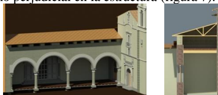
Figura 7. Propuesta de cubiertas y detalle de diseño de tijerales para el área de capilla abierta. (Elaboración propia, 2019).
