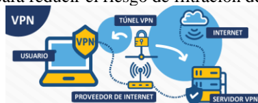
Figura 2. Funcionamiento de VPN
