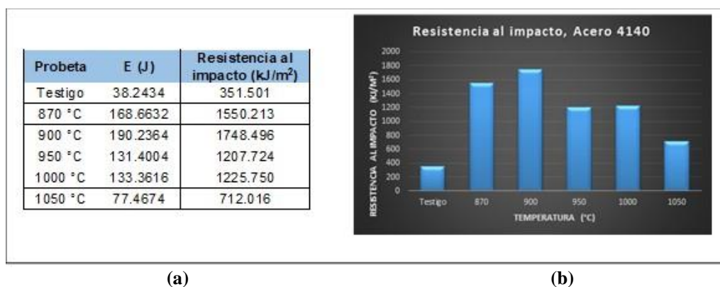
Figura 3. a) Valores de energía absorbida y resistencia al impacto y b) grafico de resistencia al impacto vs temperatura, del acero AISI/SAE 4140.
