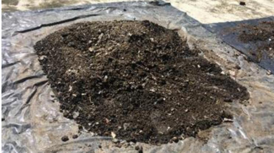
Figura 2. Material estabilizado empleado para empacar a al biorreactor utilizado en las pruebas de tratabilidad.
