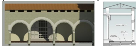
Figura 8. Propuesta de recuperación del piso de madera en capilla abierta. (Elaboración propia, 2019).
