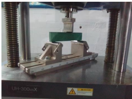
probeta instalada en la maquina Universal SHIMADZU
