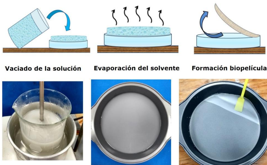
Figura 1. Proceso general de casting para elaboración de biopelículas.
