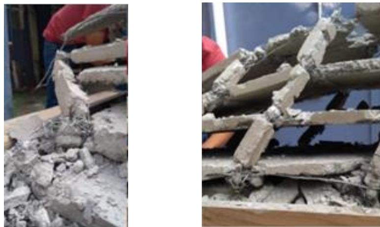
Figura 5: Respuesta sismoresistente del modelo estructural
