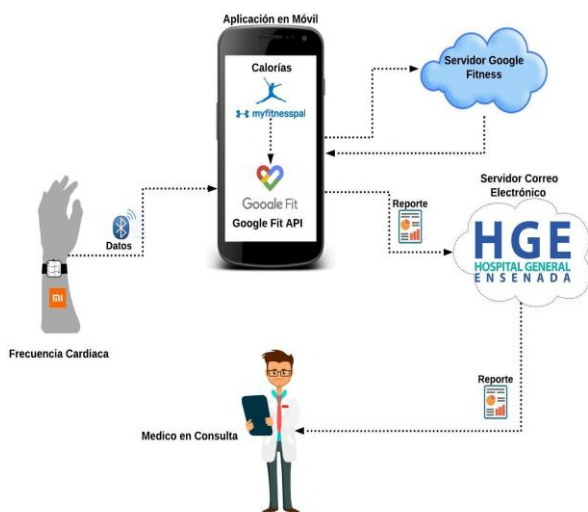
Figura 7. Arquitectura de la herramienta.
