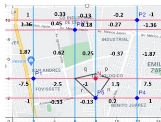
Figura 1. Ejemplo de líneas de contorno para la localización de una nueva planta.
