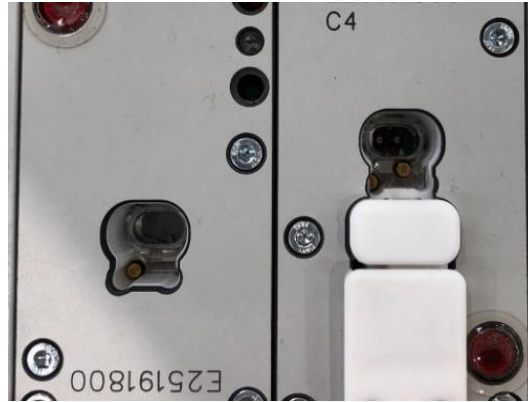
Figura 2. Sistema poka-yoke implementado.
