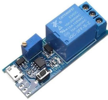
Figura 3 Relevador de 12 a 128 volts y 3 amp
