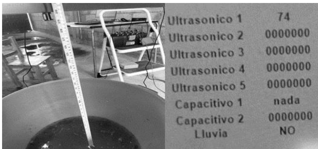
Figuras 5. Pruebas del sensor ultrasónico en agua sucia.
