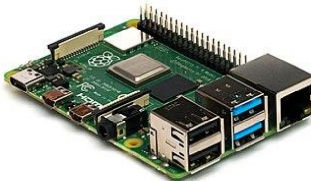
Figura 2 Raspberry Pi 4 Modelo B. Fuente: Wikimedia Commons
