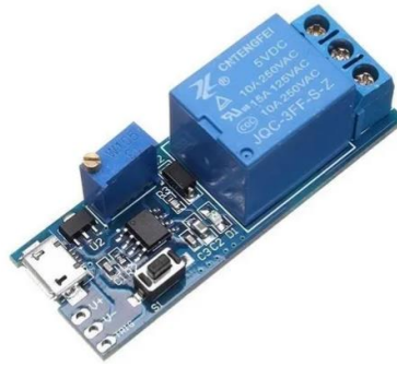
Figura 3 Relevador de 12 a 128 volts y 3 amp
