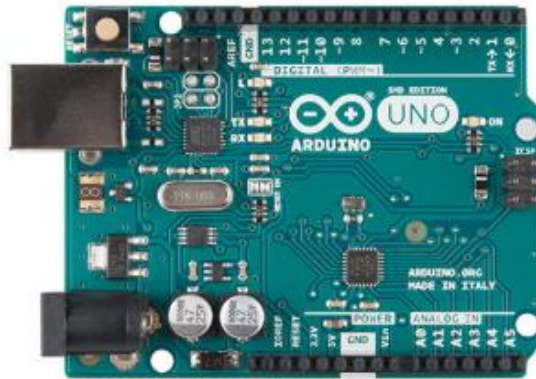
Figura 1 placa Arduino micro controlador ATMEGA328F
