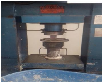
Figura 2: Preparación, Desmoldar, Curación y Ensayo de resistencia de morteros
