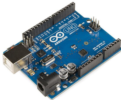
Figura 1 Arduino Uno R3. Fuente Wikimedia Commons
