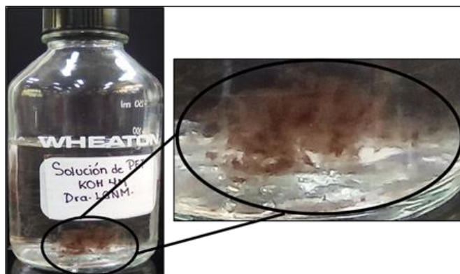
Figura 1. Conglomerado de microorganismos crecidos en un medio compuesto por un degradado alcalino de polietilentereftalato (Imagen propiedad de los autores de este trabajo)
