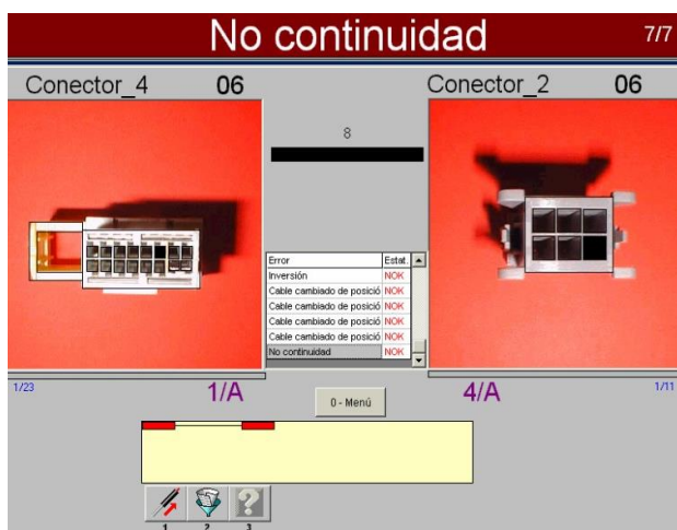
Figura 7. Sistema en acción mencionando falla de continuidad.
