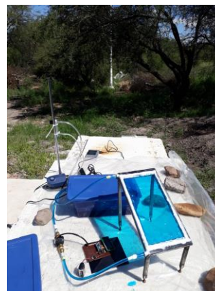
Figura 1. a) Diagrama del proceso. b) Fotorreactor (solo una celda) durante un experimento de fotólisis.
