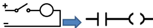
Figura 2. Cambio de representación del diagrama eléctrico a diagrama escalera (Fuente: creación propia).
