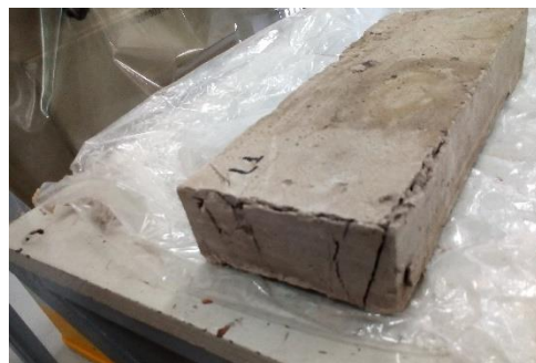
Figura 3. Punto de quiebre del ladrillo
