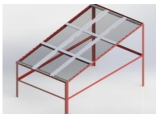
Figura 4. Fotorreactor modular (6 celdas conectadas).
