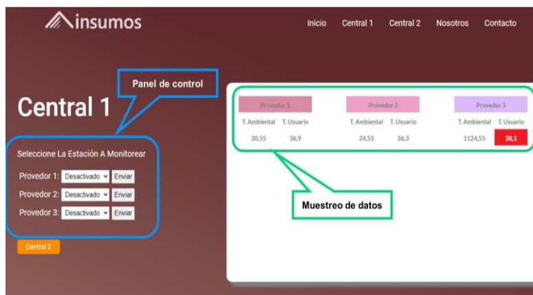
Figura 6. Diseño final del sistema de monitoreo de temperatura
