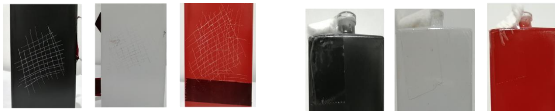
Figura 7. Pruebas de resistencia mecánica (cinta scotch) y química (resistencia a la acetona).
