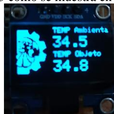
Figura 5. Pantalla OLED con datos visualizados
