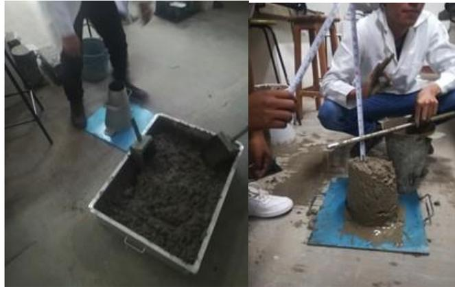
Figura 2. Prueba de revenimiento del concreto.
